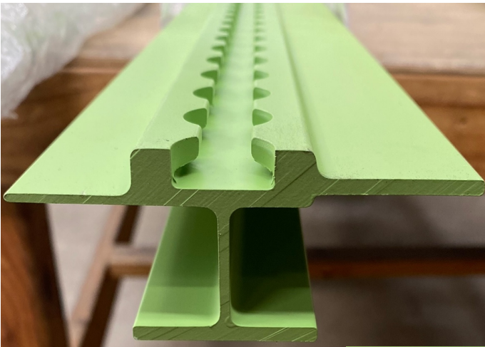
BAC1520-2193 7178-T6511 [DHCA] Chromic Acid Anodize per BAC 5019 CI 3 Primer BMS 10-11 Type I CI A Gr E per BAC 5736 Color: BAC 452 GREEN
