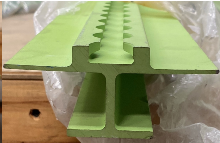
BAC1520-2192 7178-T6511 [DHCA] Chromic Acid Anodize per BAC 5019 CI 3 Primer BMS 10-11 Type I CI A Gr B per BAC 5736 Color: BAC 452 GREEN
